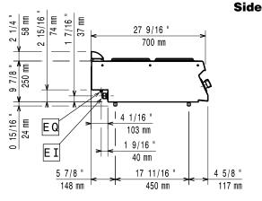
Electrical inlet (power) EQ Equipotential screw
