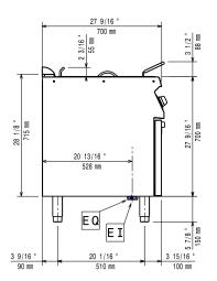
El = Electrical inlet (power) Equipotential screw
